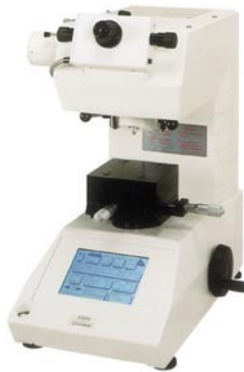
Figura 14 - Microdurômetro Shimadzu HMV 2
