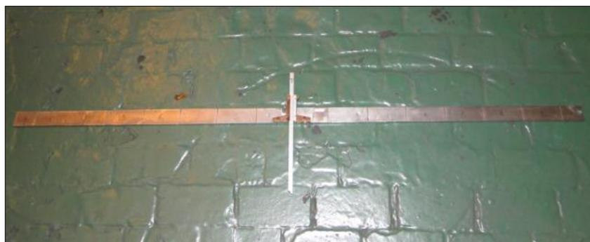
Figura 26.a - Ondulômetro utilizado (Fonte: CSN)
