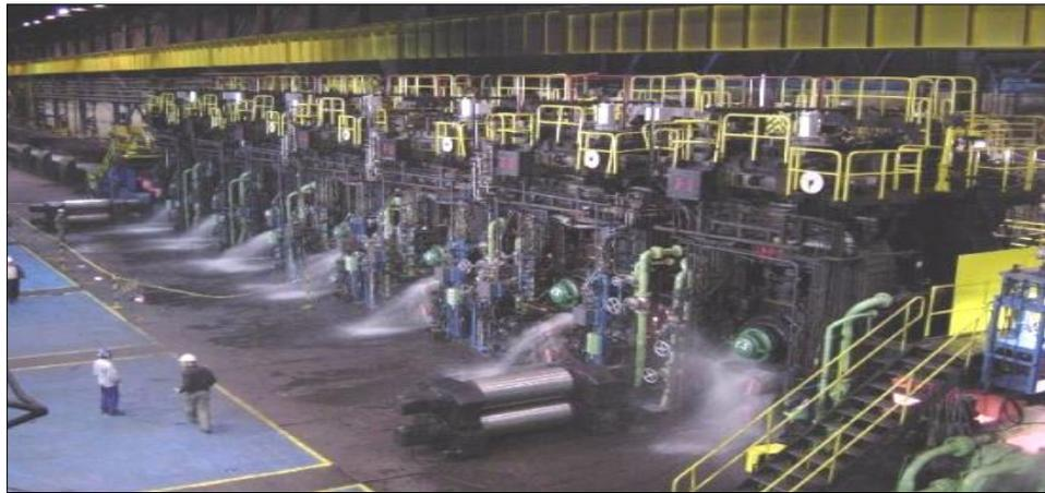
Figura 8 - Laminador de Acabamento LTQ#2 (Fonte: CSN)
