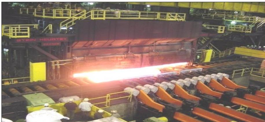
Figura 6 - Fornos reaquecimento de placas LTQ#2 (Fonte: CSN)
