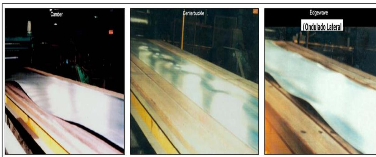
Figura 1 – Exemplo de Bobinas com Desvio de Planicidade (Fonte: [3])
