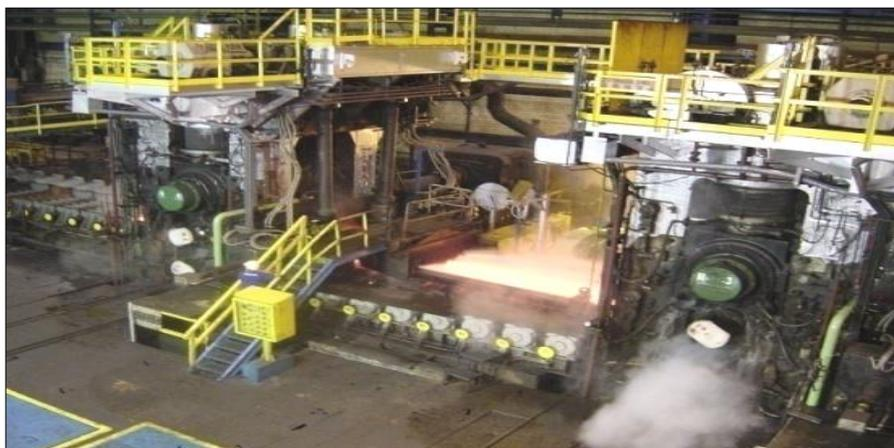
Figura 7 - Laminador de Desbaste LTQ#2 (Fonte: CSN)
