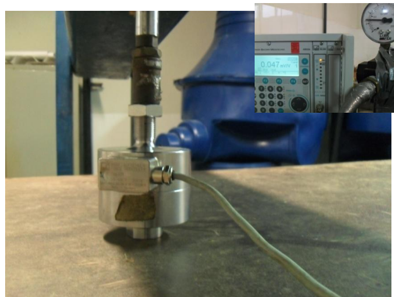
Figura 36 - Averiguação da carga aplicada pela célula de carga. Fonte: Autor.
