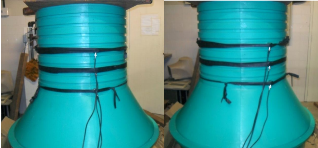
Figura 44 - Ensaio de emissão acústica na chaminé do PV na posição 1e na posição 2 (+15cm).
