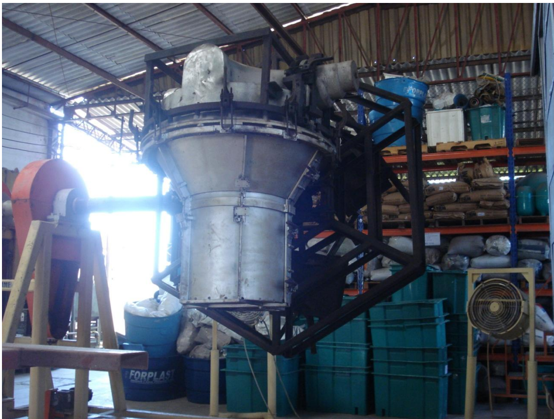
Figura 18 - Molde para produção do PV em polietileno. Fonte: Autor.
