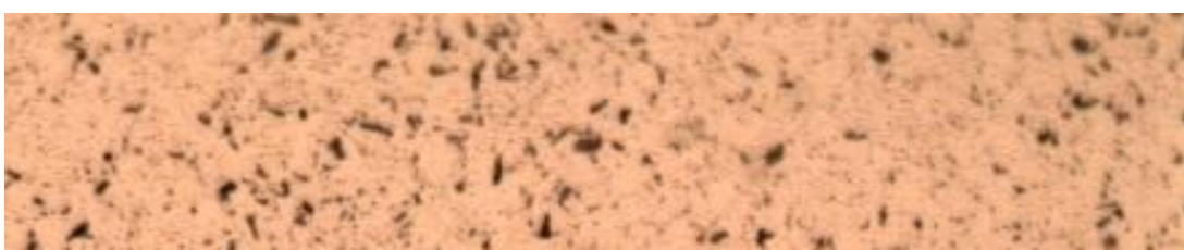
Figura 02 - Micrografia do fio da camada externa do cabo da liga de Alumínio 6201 Recozimento Pleno com resfriamento moderado. 0 meses.
