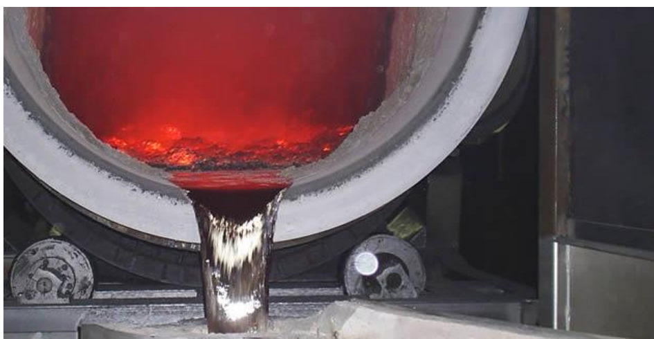
Figura 18 - Fundição de Zinco: Produção de Ligas Zamak [27]
