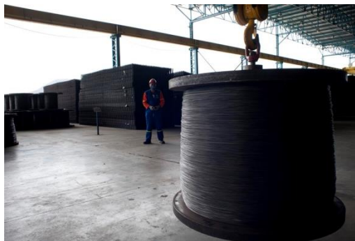
Figura 2. Fio-máquina utilizado para a produção do CA-60.
