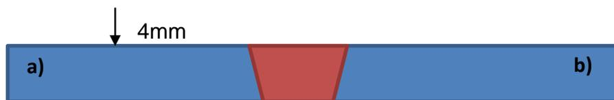
Figura 21– Chapas soldadas em Overlap – a) 316L b) 444
