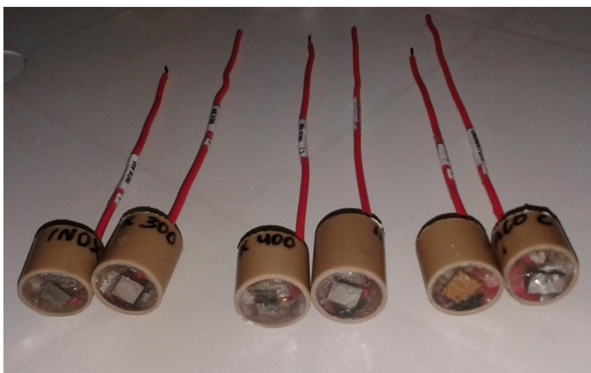
Figura 12 – Eletrodos de trabalho montados para a realização de ensaios eletroquímicos.
