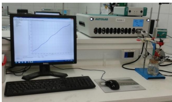
Figura 14 – Arranjo completo para aquisição das curvas de polarização.
