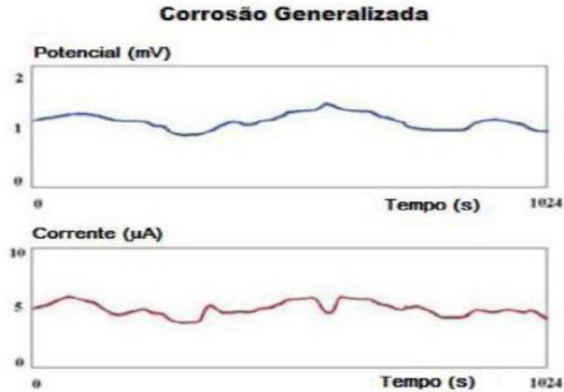
Figura 3 – Corrosão uniforme (BULLARD et. al., 2002).
