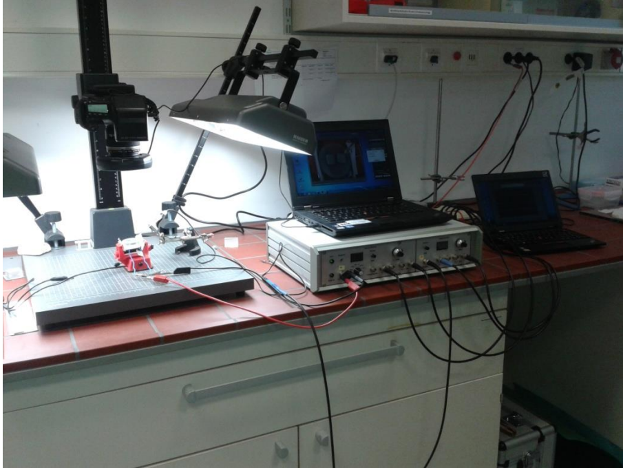
Figura 9. Configuração experimental dos testes conduzidos com Korropad, mostrando o sistema de câmera digital a esquerda acoplado ao sistema de medidas dos sinais de ruído à direita.
