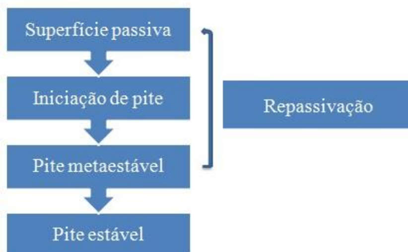
Figura 1. Estágios da corrosão por pite a partir de uma camada passiva até o crescimento de pite estável.
