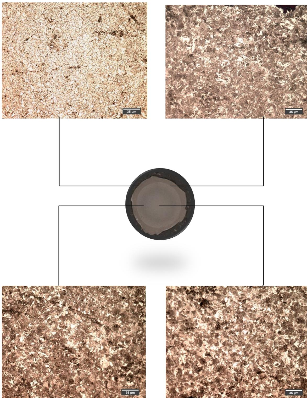
**Figura 32 – Microestrutura, obtida por microscópio óptico 500X de aumento, das camadas 1, 2, 3 e 4 do vergalhão de bitola 10 mm.**
