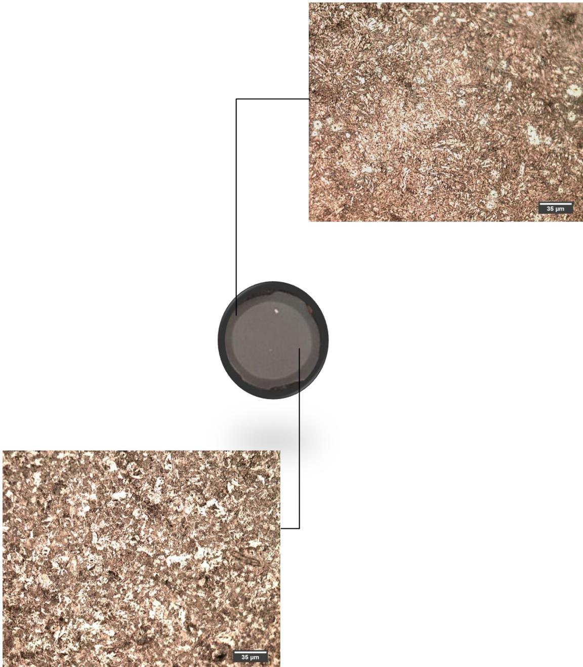
**Figura 31 – Microestrutura, obtidas por microscópio óptico 500X de aumento, das camadas 1 e 2 do vergalhão de bitola 8 mm.**
