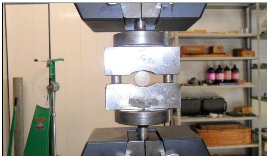
Figura 18 - Corpo de prova em posição antes do início do ensaio de compressão diametral após aplicação de uma pequena carga de compressão para acoplamento.
