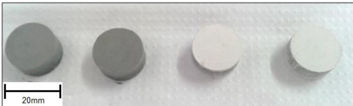
Figura 13 – Peças a verde compactadas nas composições de 20%p de resíduos do carvão mineral e 0%p de resíduos do carvão mineral, respectivamente.
