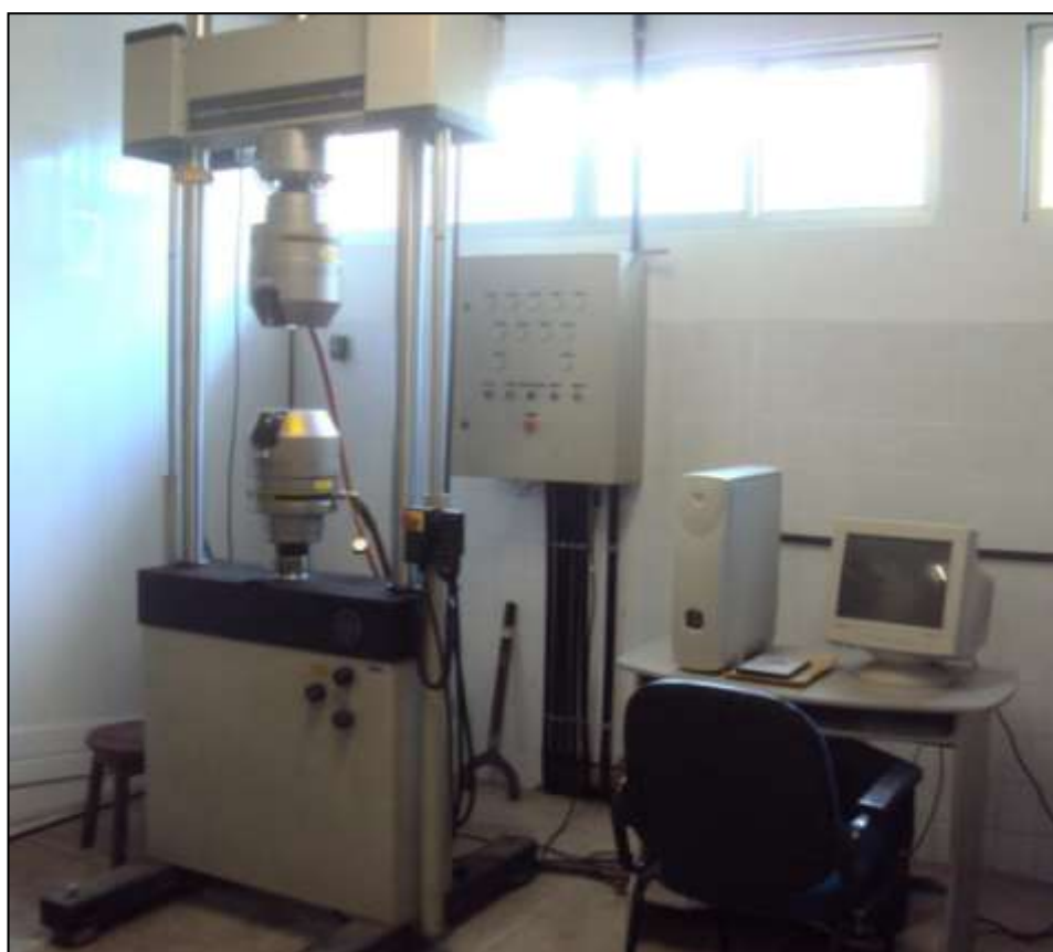
Figura 13. Máquina de ensaios mecânicos INSTRON (Laboratório de Ensaio Mecânicos da UFC).
