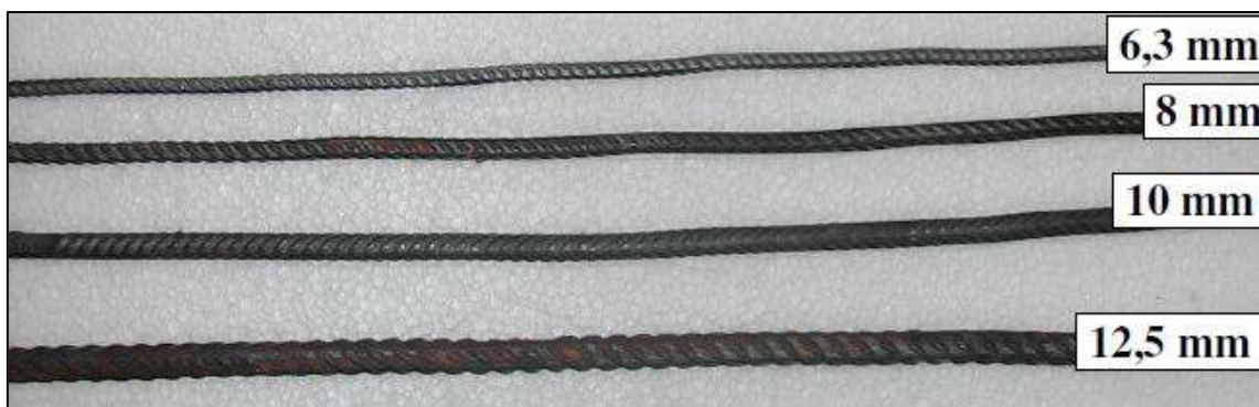
Figura 14. Corpos de prova de diferentes diâmetros nominais usados no ensaio de tração (NETO, J.B.R, 2010).
