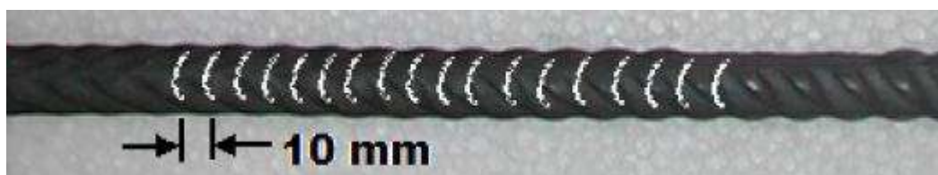
Figura 15. Esquema das marcações realizadas para determinação do comprimento final (NETO, J.B.R, 2010).
