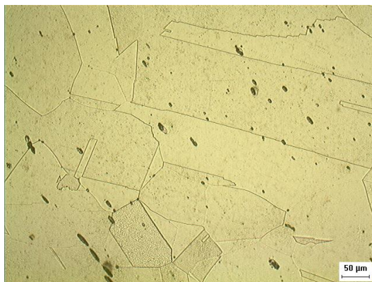
Figura 37. Amostra C solubilizada seguida do tratamento CK (600°C 1h).
