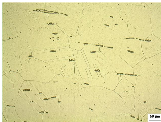
Figura 40. Amostra D solubilizada seguida do tratamento DL DK (600°C 1h).
