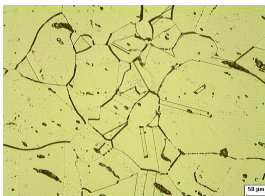
Figura 26. Microestrutura resultante do tratamento CL (600°C 5h).
