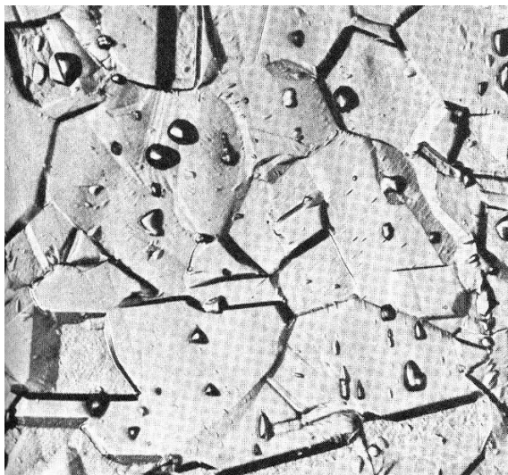
Figura 9. Estrutura Step (500 x) (Degraus entre os grãos com ausência de precipitados nos contornos dos grãos) (ASTM, 1994).
