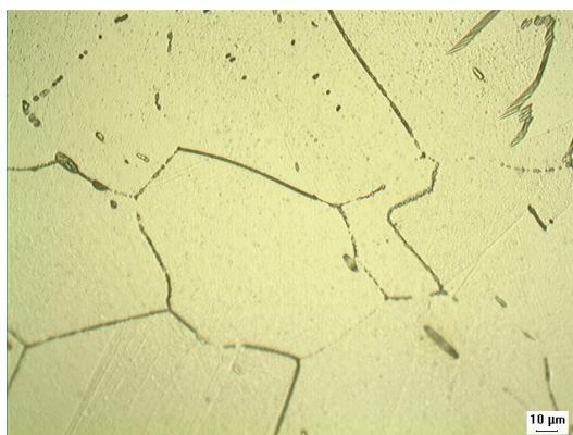
Figura 39. Amostra C solubilizada seguida do tratamento CT (700°C 100h).
