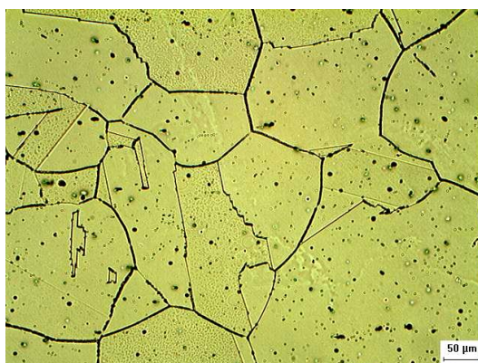
Figura 53. Microestrutura de uma região próxima ao cordão de solda apresentando uma maior quantidade de precipitados (0 mm a 2mm) da zona fundida.
