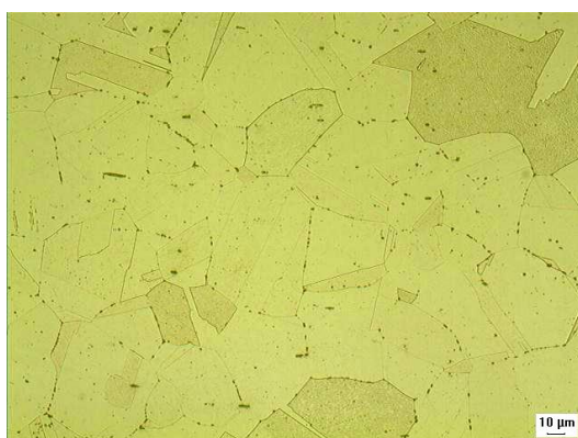
Figura 55. Microestrutura de uma região situada entre (4 mm a 6mm) da zona fundida.
