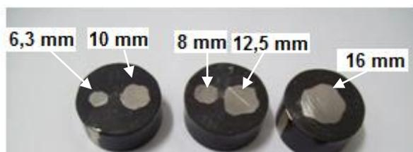
**Figura 21.** Amostra embutidas prontas para o processo metalográfico.
