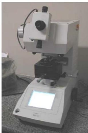
**Figura 24.** Microdurômetro Shimadzu HMV-2 utilizado para a realização do ensaio de microdureza Vickers.
