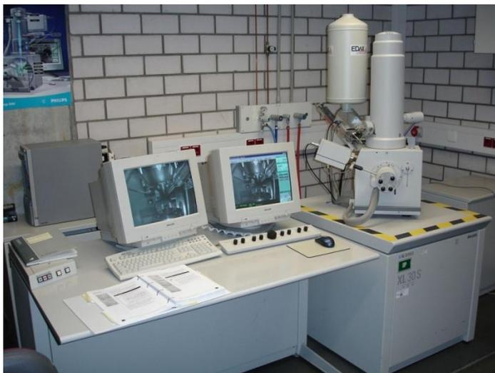
**Figura 25.** Microscópio eletrônico de varredura Philips XL 30S FEG.
