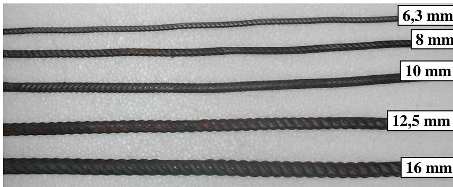
**Figura 19.** Corpos de prova de diferentes diâmetros nominais usados no ensaio de tração.
