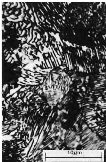
**Figura 13.** Micrografia de um aço eutetóide, mostrando uma estrutura de perlita grossa (CALLISTER, 2007).
