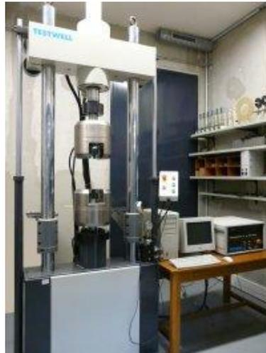
**Figura 17.** Máquina de ensaios mecânicos DARTEC.
