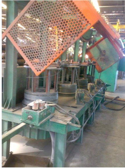
Figura 15. Máquina de Trefilação com 4 passes. (Foto fornecida pela MMAia)
