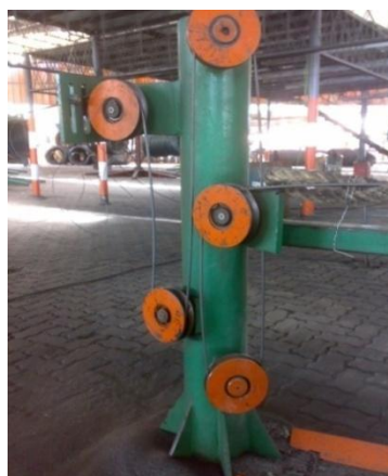
Figura 5. Decarepador mecânico utilizando 5 roldanas (Foto fornecida pela MMAia).
