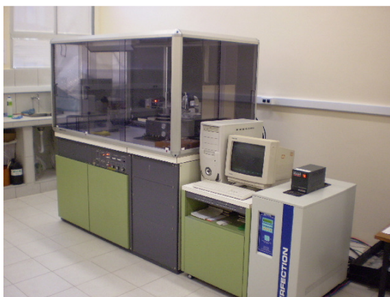
Figura 27. Difratômetro de raios-x utilizado na análise das fases da escória do FEA estudado.
