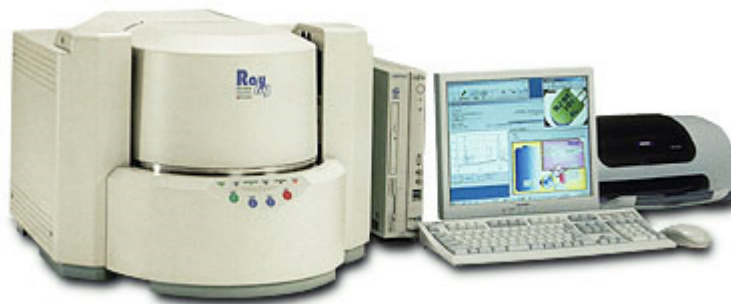
Figura 25. Equipamento de fluorescência de raio-x utilizado para determinação da composição química das escórias do FEA estudado (EDX-720 da marca shimadzu).
