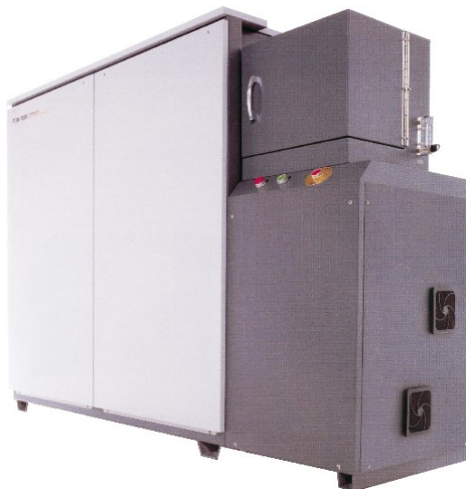
Figura 21. Espectrômetro utilizado para análise química das sucatas do FEA estudado.
