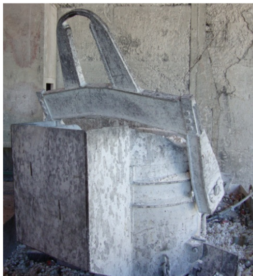
Figura 44. Dosador de cal utilizado para a adição de cales no FEA estudado.
