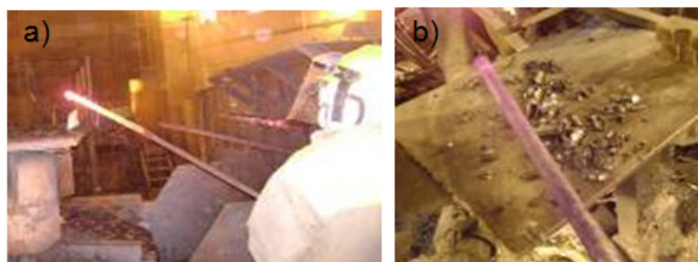
Figura 24. a-Coleta de amostra de escórias utilizando uma vara metálica. b-escória solidificada na superfície da vara.
