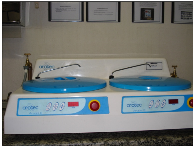
Figura 28. Politriz usada para o lixamento e polimento das amostras de escórias.
