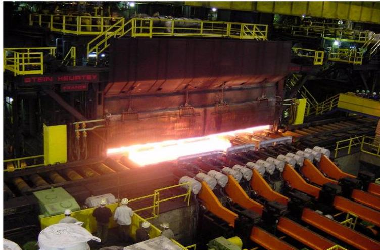
A principal função dos fornos de reaquecimento é elevar a temperatura dos lingotes de aço (ou placas), até torná-las plásticas o suficiente para serem processadas no processo de laminação a quente, para obtenção da seção desejada (dimensão e/ou formato) [2].
