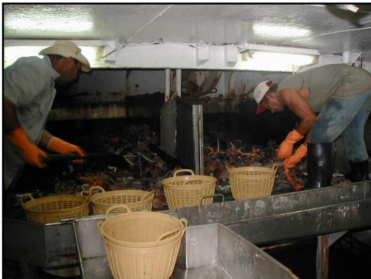
Figura 32 – Tripulação iniciando os preparativos no compartimento de recepção para a seleção do pescado, com os cestos plásticos próximos à canaleta (inferior) utilizada para o descarte de resíduos e fauna acompanhante.
