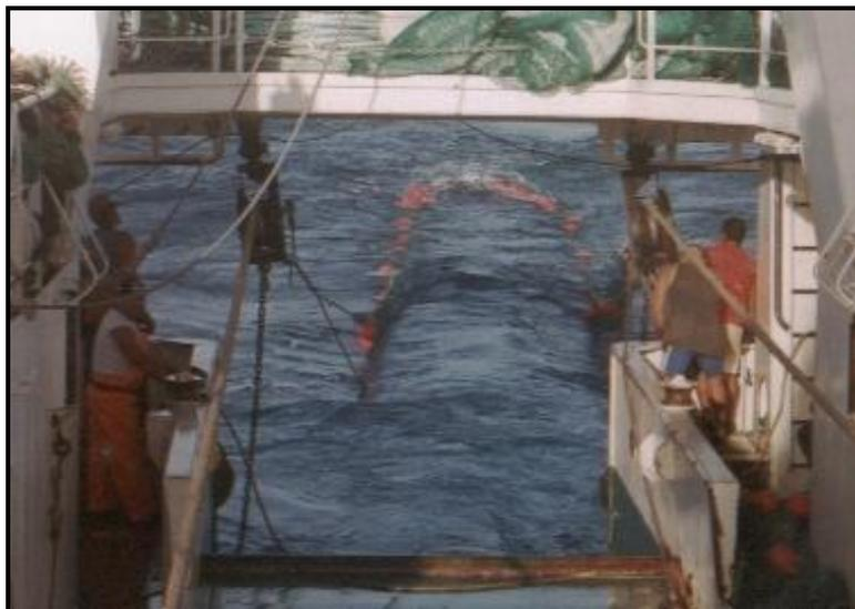
Figura 26 – Rede de arrasto durante a operação de lançamento apresentando os cabos da manga de boreste trançados.
