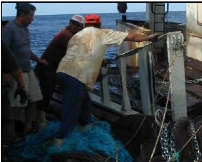
Figura 16 – Estrutura (cavalo) utilizada para proporcionar a estabilidade e assentamento adequado das redes gêmeas no fundo.
