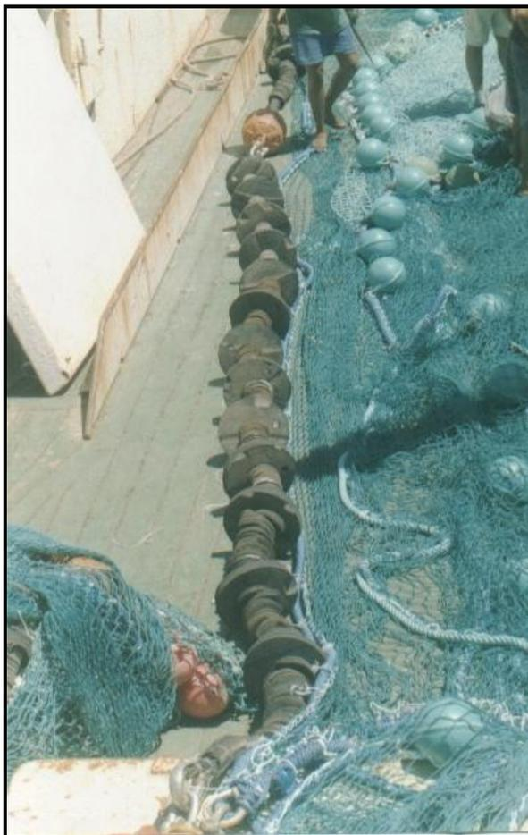
Figura 10 – Detalhe dos discos de borracha na tralha inferior da rede de arrasto utilizada na pesquisa para a captura de recursos demersais de grande profundidade.
