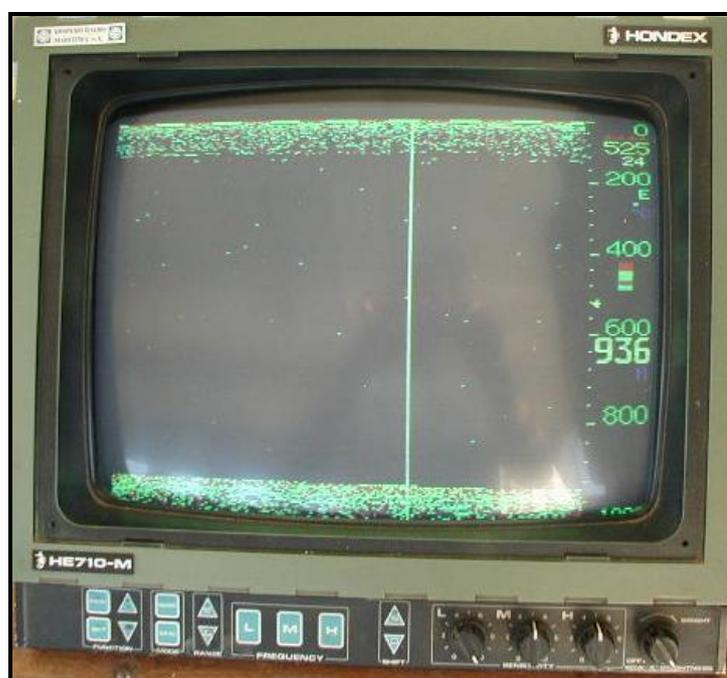
Figura 24 – Eco sonda colorida apresentando uma área com um fundo de 936 m, de lama e liso, que era analisado através do registro numérico, coloração dos ecos e regularidade do substrato apresentado na tela.
