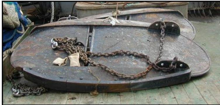
Figura 19 – Portas ovais utilizadas em pescarias exploratórias na costa norte do Brasil.
