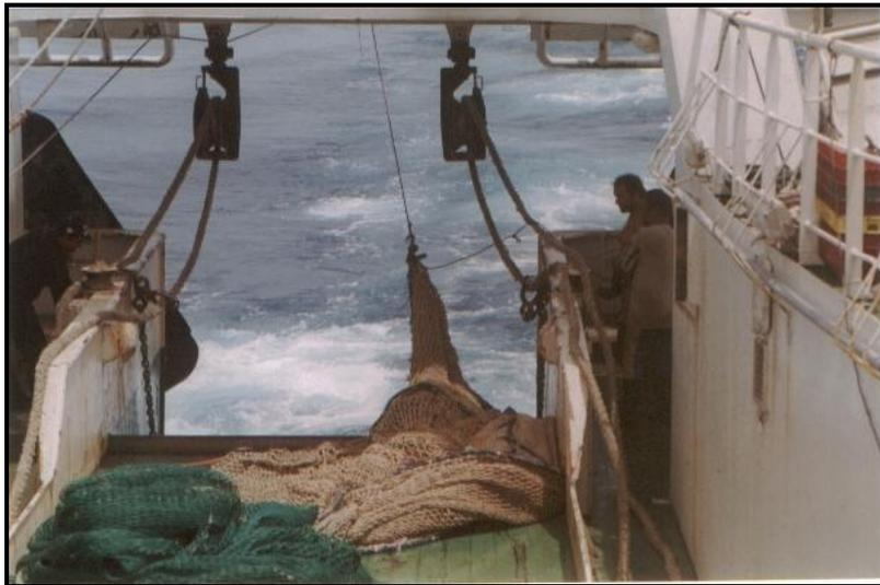
Figura 25 – Início dos lançamentos através da liberação do saco da rede para a água nas pescarias na costa norte do Brasil utilizando o sistema de arrasto de popa com rede única.
