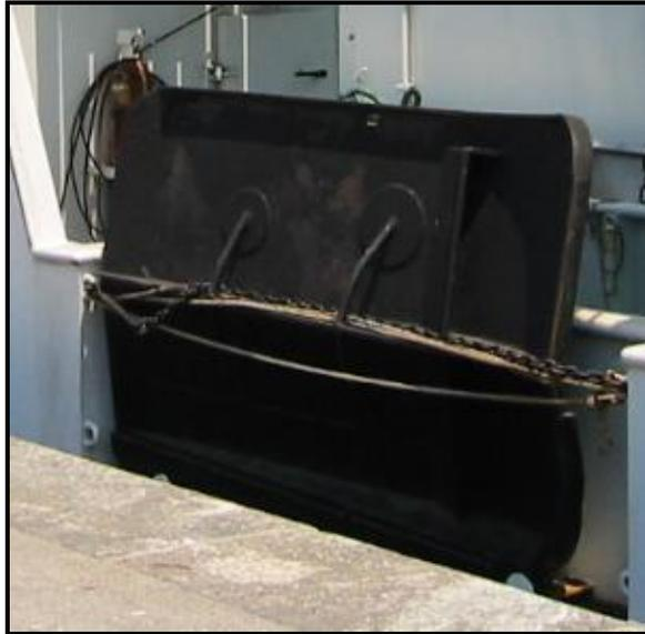
Figura 20 – Portas retangulares de aço utilizadas em pescarias exploratórias na costa norte do Brasil.
