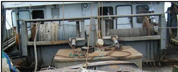
Figura 8 – Vista frontal dos tambores do guincho hidráulico do B.p. Noé que foi utilizado nas pescarias exploratórias.
