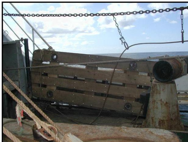
Figura 21 – Portas retangulares de madeira utilizadas em pescarias exploratórias na costa norte do Brasil.
