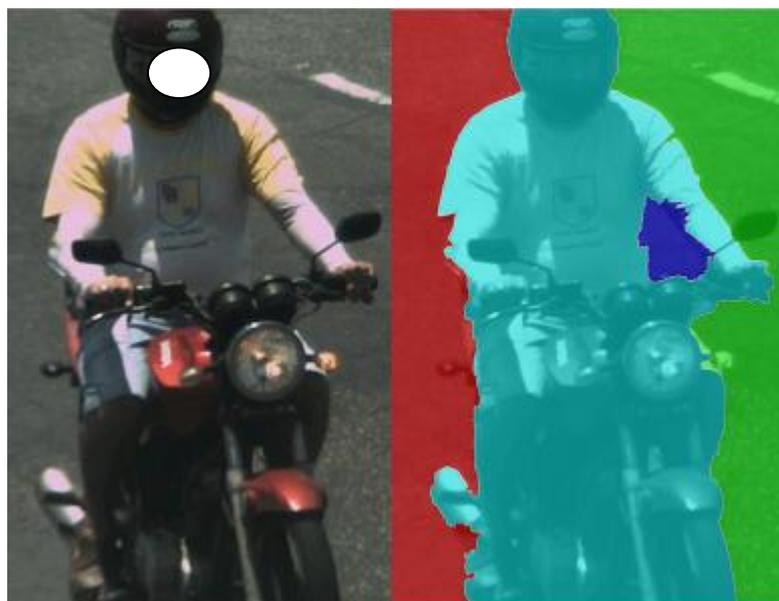
Figura 4 - Imagem do motociclista no padrão RGB(esquerda) e ao lado a imagem processada pelo algoritmo *Watershed* (direita).
