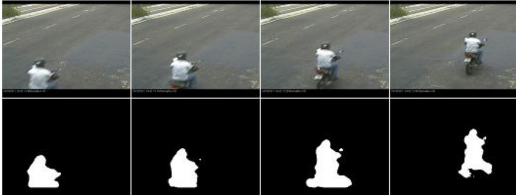
Figura 16 – Frames de um vídeo sendo processado pelo o algoritmo *Background Subtractor*.
