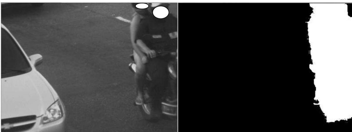
Figura 22 – Exemplo de uma imagem removida. É notória a dificuldade de se identificar o número de passageiro somente com o contorno. Na imagem à esquerda é possível observar que o motociclista está incompleto.
