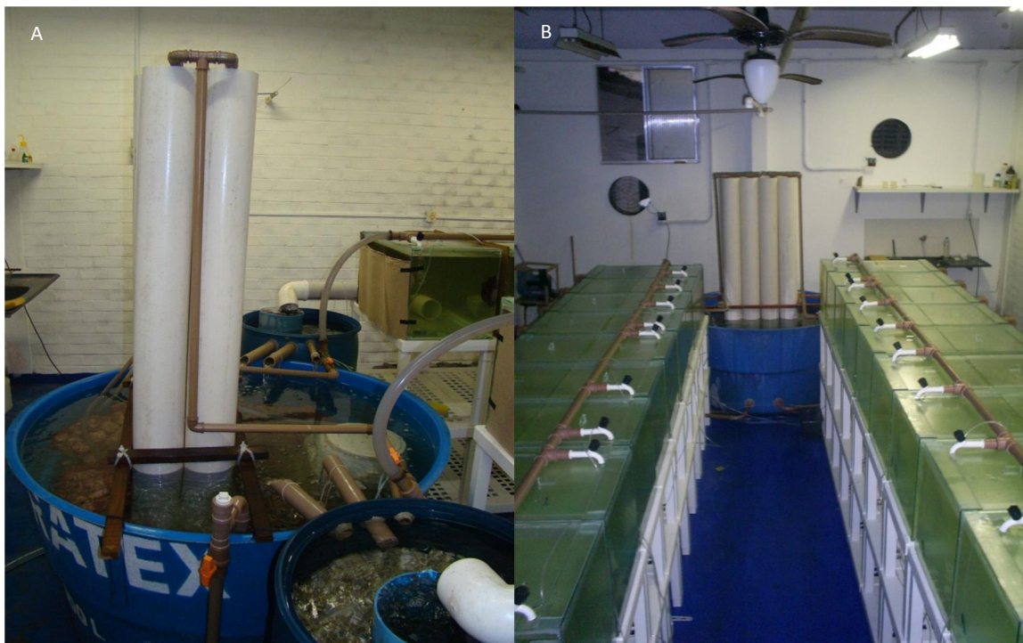
Figura 8: Filtro secundário de torres; A – vista lateral; B – vista frontal.
