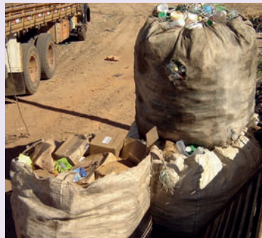
Resultado do tratamento (triagem) de resíduos sólidos (metais à esquerda, papelão e plásticos à direita) num aterro de uma localidade do interior do Nordeste brasileiro.
