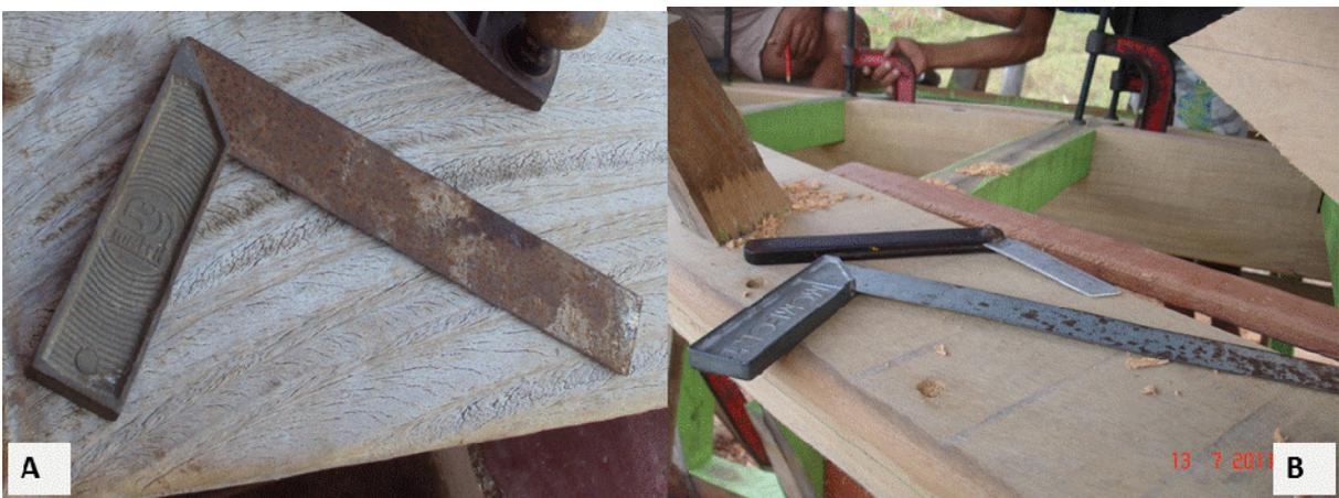
Figura 29 – Esquadro: A- posição estática; B - na embarcação, pronto para utilização. (Fonte: Fotos do autor)
