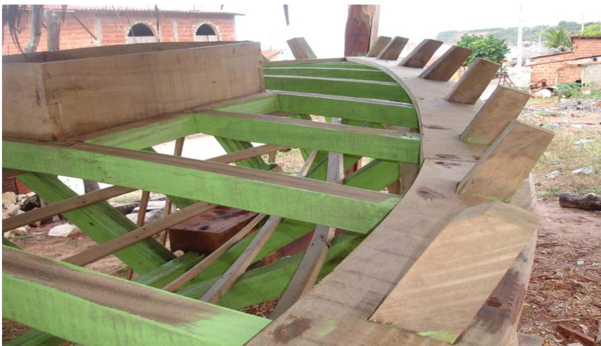
Figura 42 – Tabica já encaixada nas pontas de cavernas e assentada sobre as latras. (Fonte: Foto do autor)
