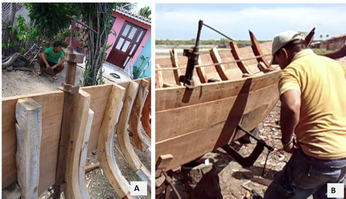
Figura 25 – Sargento: A – visto pela parte interior da embarcação; B – pela parte externa fazendo a junção das tábuas. (Fonte: Fotos do autor)
