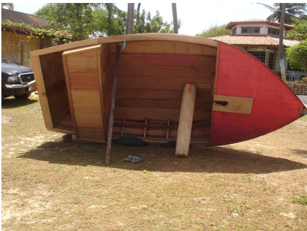
Figura 14 – Canoa paquete de Flecheiras vista da parte interior. (Fonte: foto do autor)
