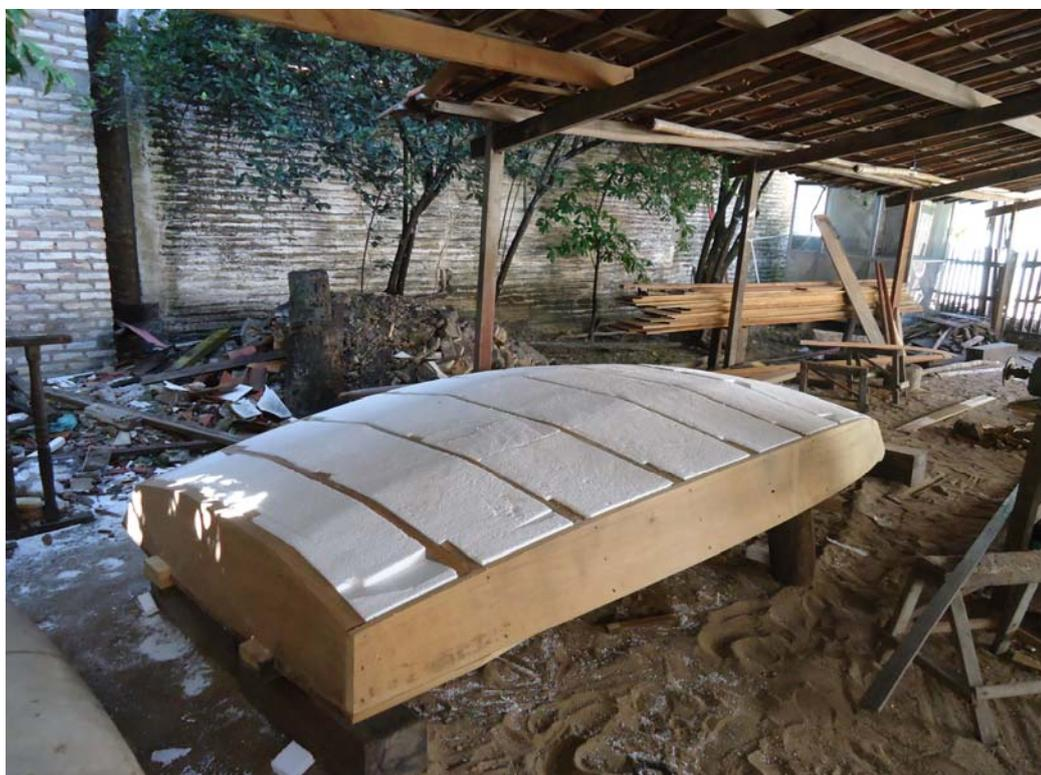
Figura 7 – Paquete revestido de isopor denominado popularmente de paquete de isopor. (Fonte: foto do autor)
