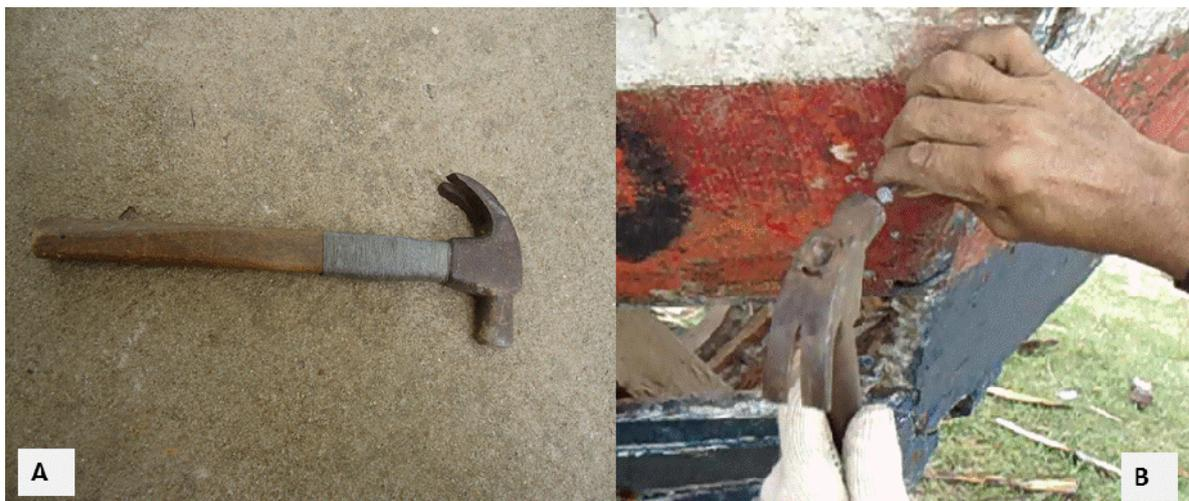
Figura 18 – Martelo de unha: A - posição estática; B - em dinâmica de utilização. (Fonte: Fotos do autor)
