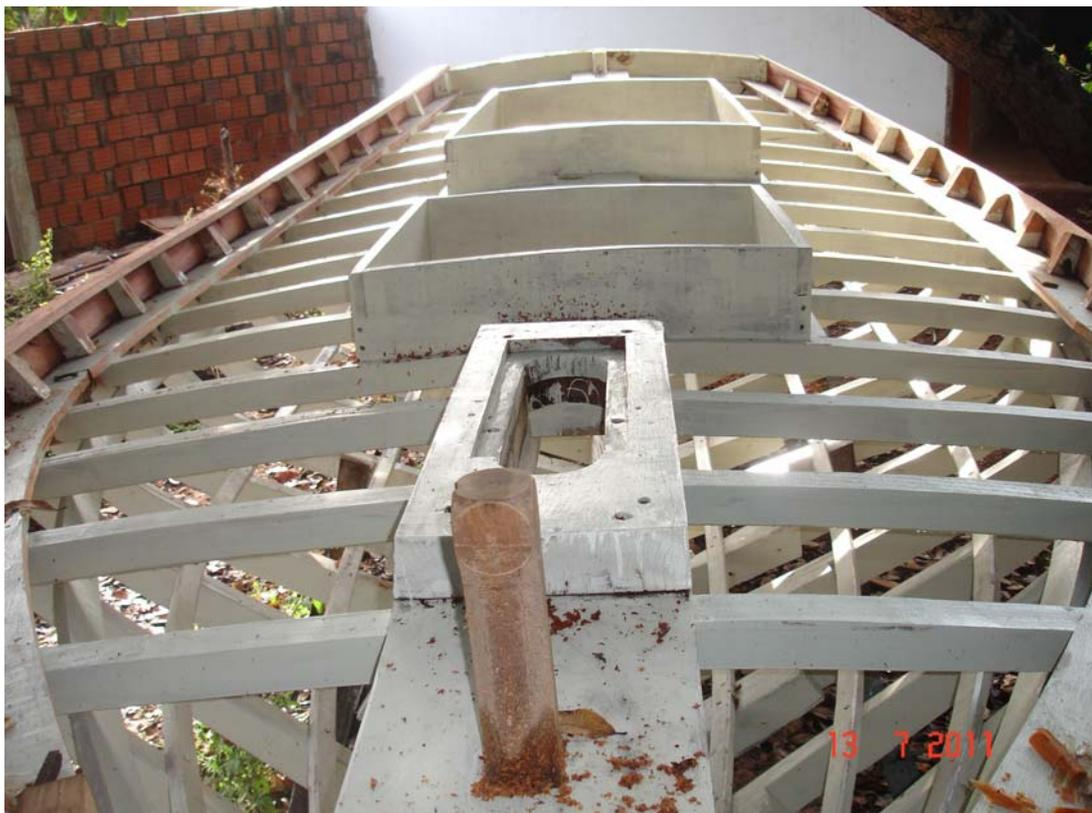
Figura 11 – Curvatura das latras com diminuição gradativa do tamanho e curvatura para vante e para ré. (Fonte: foto do autor)
