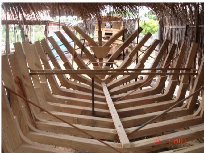
Bote triângulo sendo construído no estaleiro coberto de palha.
