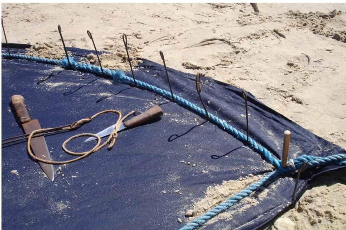
Figura 46 – Ferramentas utilizadas para corte e confecção da vela na praia. (Fonte: Foto do autor)
