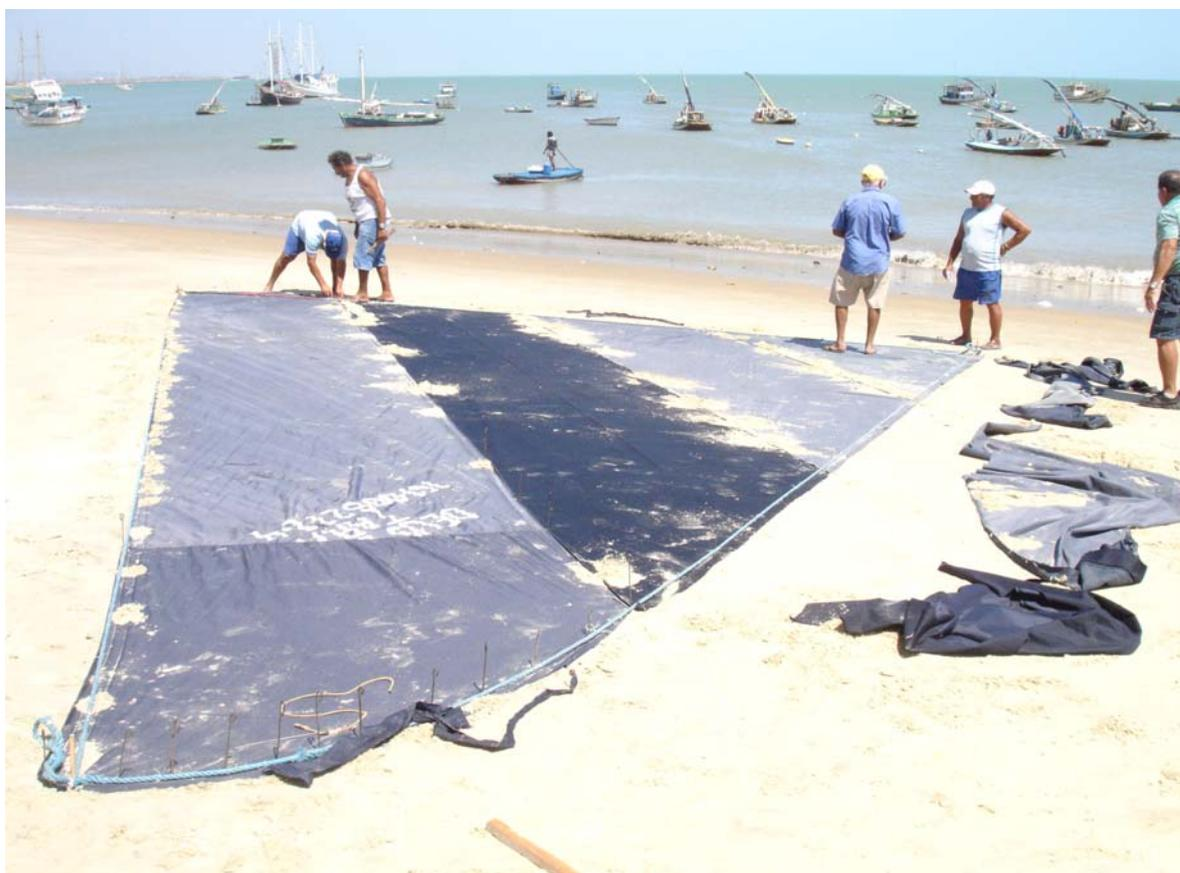
Figura 48 – Desenho e construção da vela sendo confeccionada por feitor de vela na areia da praia do Mucuripe-Fortaleza. (Fonte: Foto do autor)
