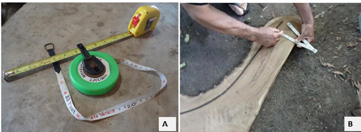
Figura 32 – Instrumentos de medição: A - fita métrica e trena; B – escala métrica em medição de caverna. (Fonte: Fotos do autor)
