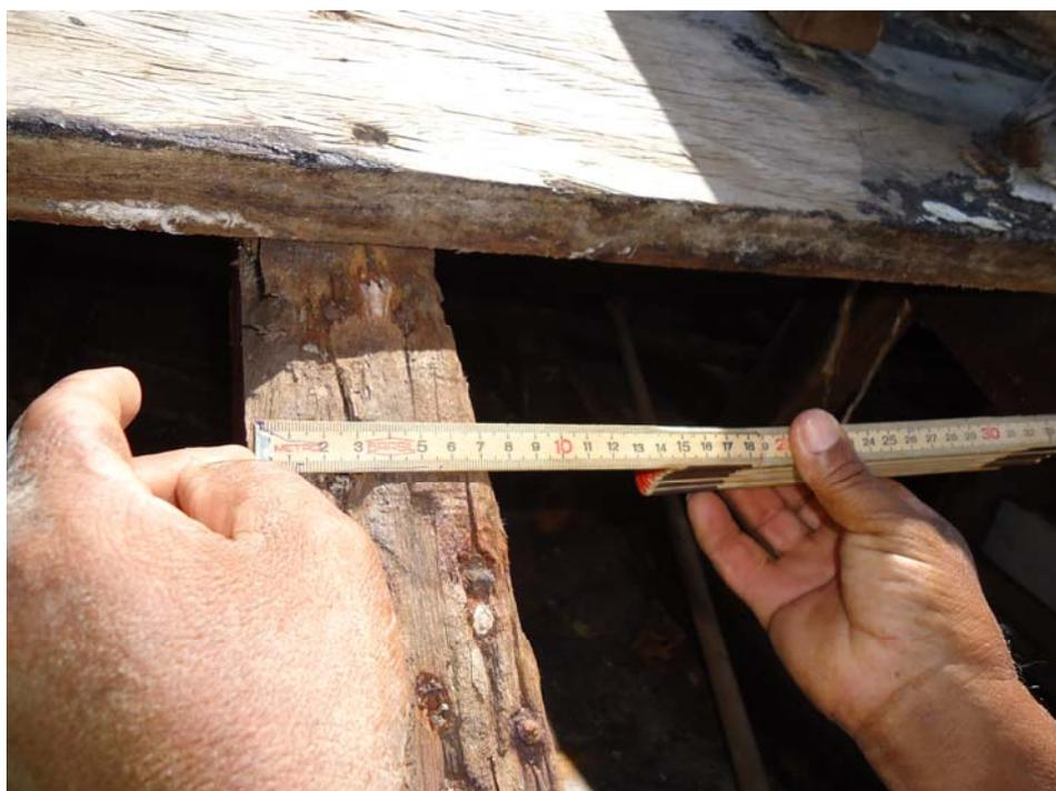
Figura 7- Medição da largura da caverna com escala métrica. (Fonte: foto do autor, ano 2012)
