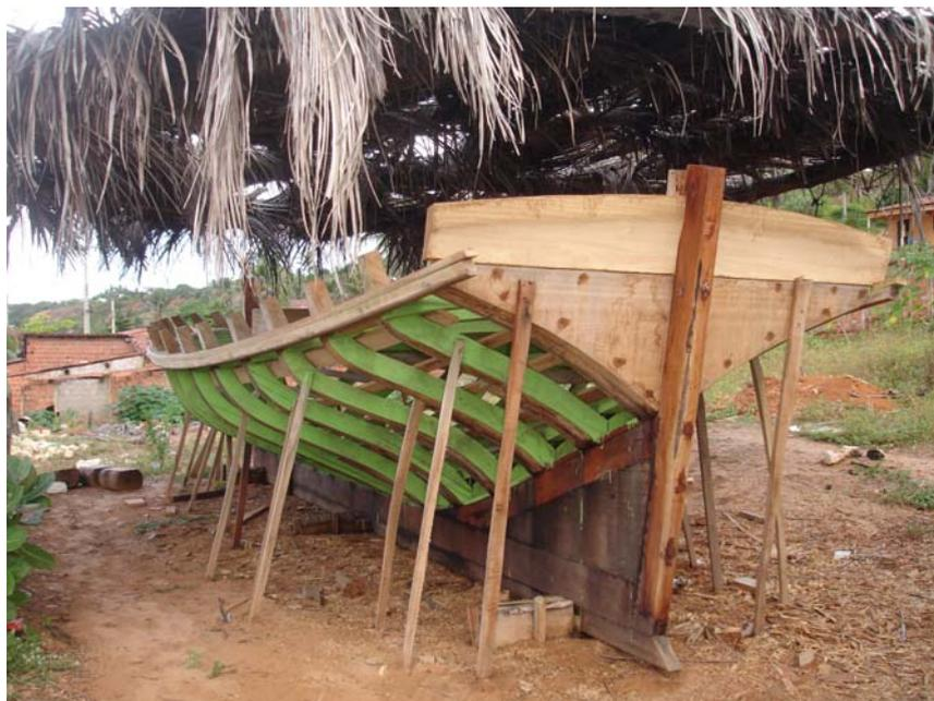
Figura 9 – Bote no estaleiro com escoramento e fixação.
