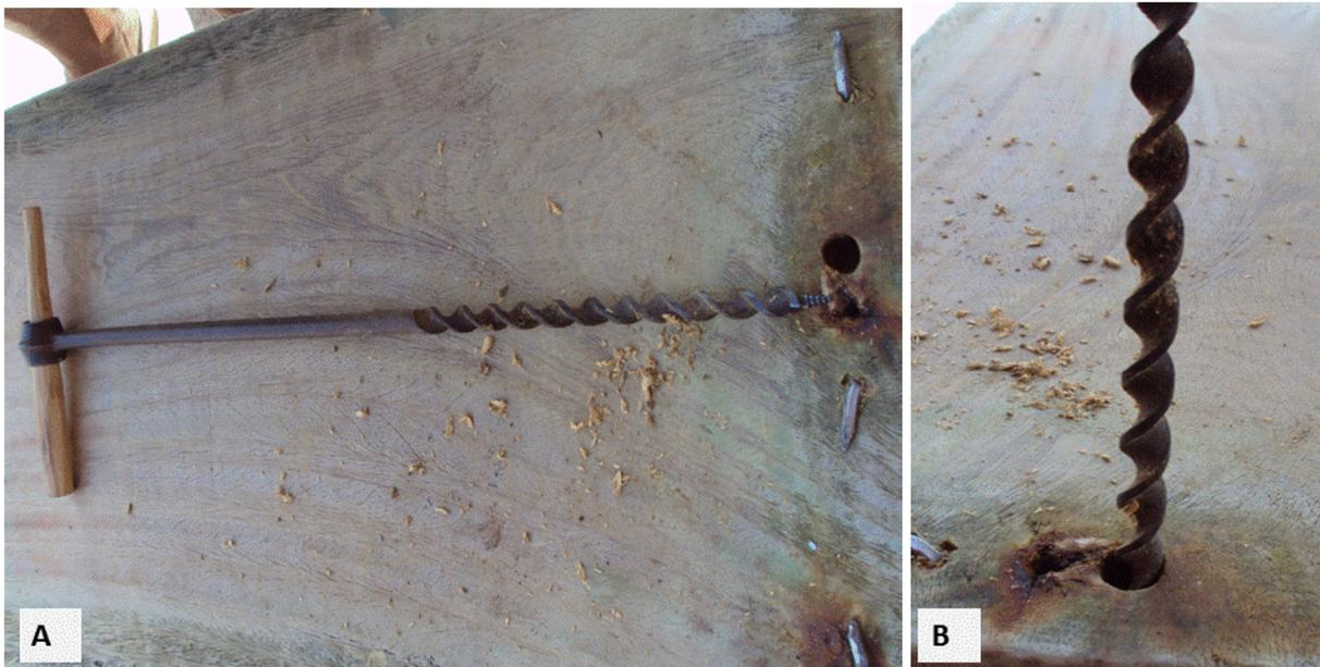
Figura 26 – Trado: A – posição estática; B – em dinâmica de utilização. (Fonte: Fotos do autor)
