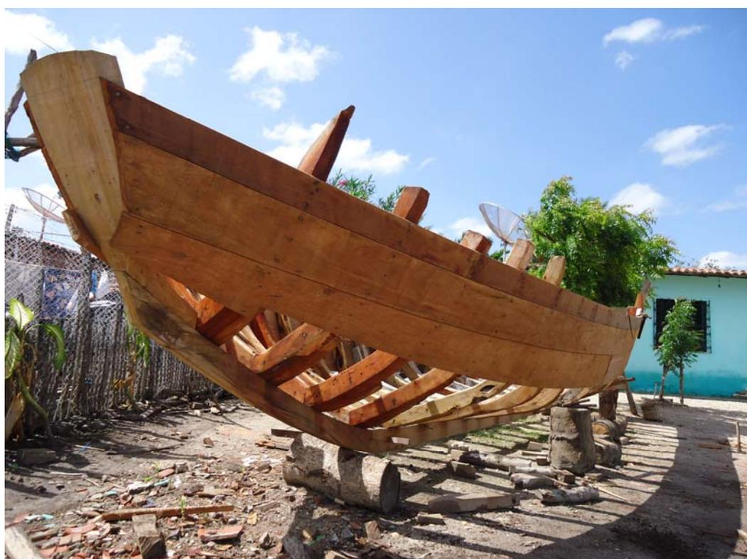
Figura 5 – Construção de uma canoa em estaleiro improvisado totalmente ao relento, à margem da estrada na Ilha dos Coqueiros, em Acaraú, Ceará. (Fonte: foto do autor, ano 2012)
