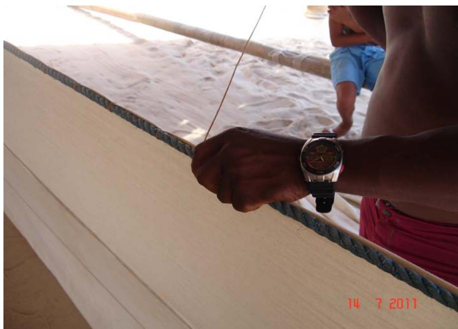
Figura 43 – Entalhando o cabo da vela com agulha e costura de palombar. (Fonte: Foto do autor)
