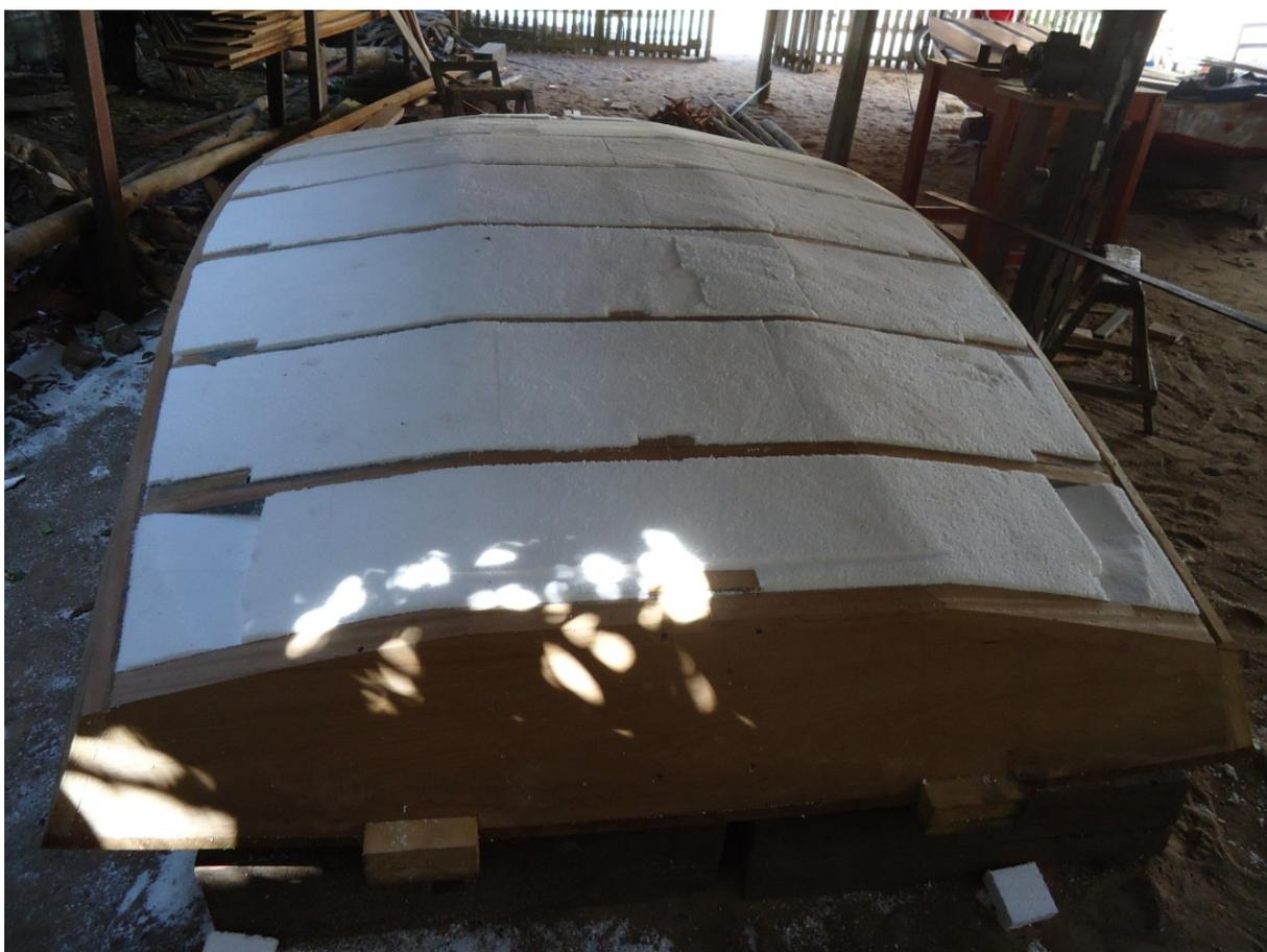
Figura 2 – Vista da parte inferior de uma jangada de isopor na fase de construção.
