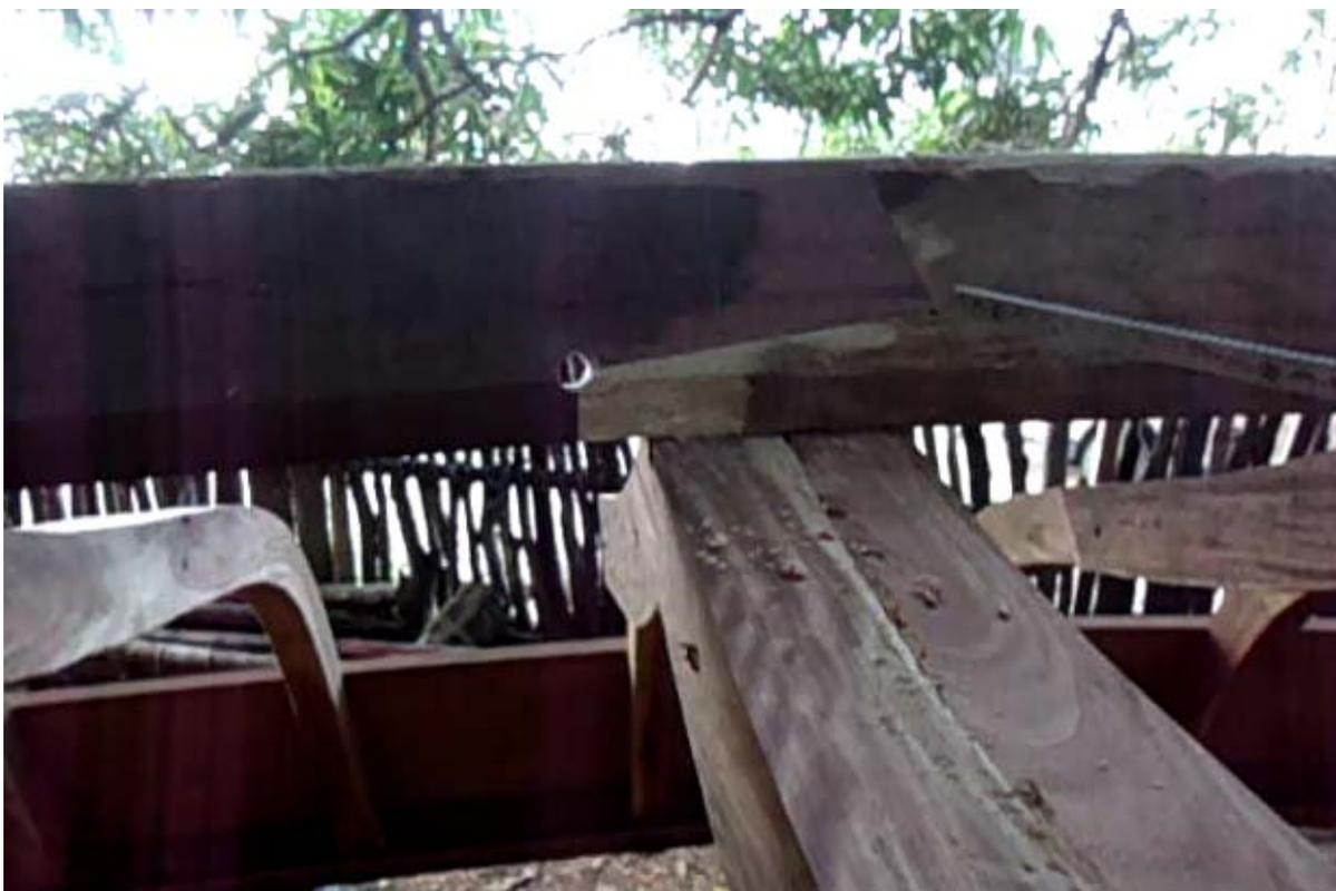
Figura 37 - Escarfa lisa antes da colocação da cavilha d'água na quilha de uma canoa biana visto antes da colocação do tabuado (canoa está emborcada). (Fonte: Foto do autor)
