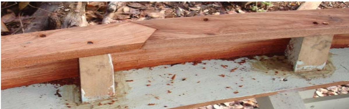
Figura 40 – Tipo de emenda utilizada no corrimão de bote. (Fonte: Foto do autor)
