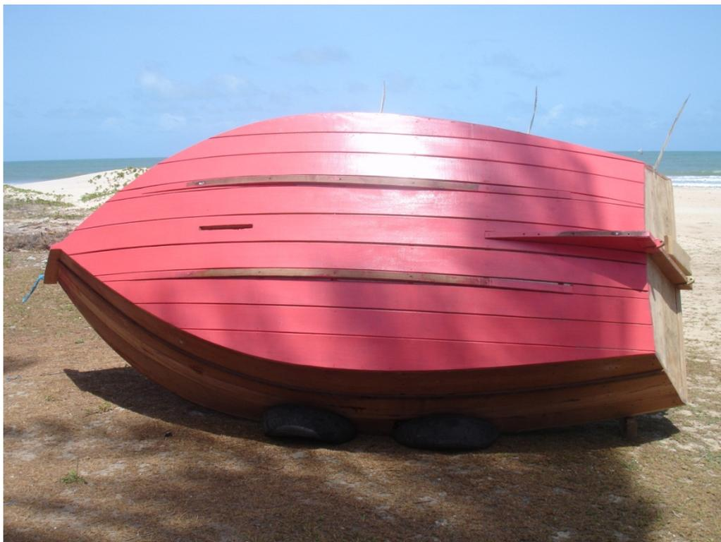
Figura 15 - Canoa pacote de Flecheiras vista da parte externa e fundo. (Fonte: foto do autor)
